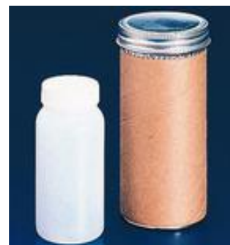
Қорғаныс корпусына (капсулаға) салынған герметикалық жабылған пластикалық биоматериал құтысы
