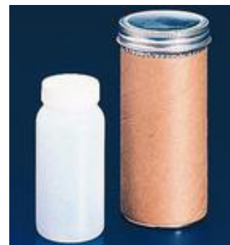
Пластиковый герметично закрытый флакон для биоматериала, помещенный в защитный футляр (капсулу)
