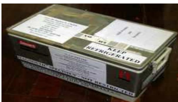
Биологиялық материалдардың салыстырмалы түрде үлкен көлемін тасымалдау кезінде тасымалдау контейнерлері – чемодандар пайдаланылады, онда температура -15\div-18 °C деңгейінде сақталатын
