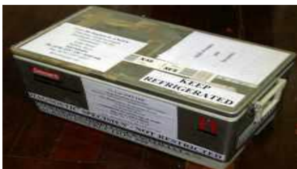
При транспортировке сравнительно больших объемов биологических материалов используются транспортные контейнеры – чемоданы, температура в которых поддерживается на уровне -15 \div -18 °C
