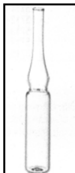
Стеклянная ампула для хранения сублимированных культур микроорганизмов
