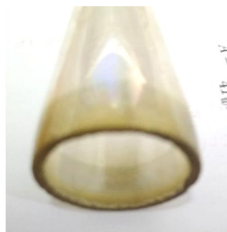
б) Диафрагма после эксперимента (видно, что на внутренней стороне образовалась тонкая пленка после катодного напыления)
