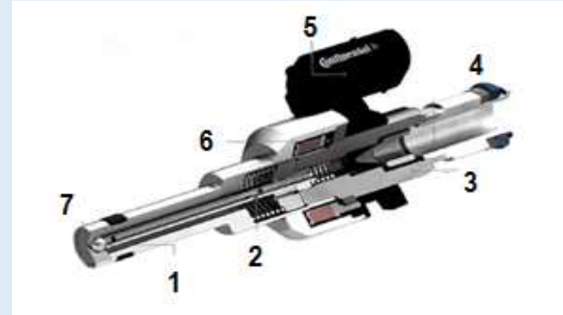
1 – игла, 2 – клапан, 3 – корпус инжектора, 4 – привод топлива, 5 – электрический разъем, 6 – силовой привод, 7 - сопло Рисунок 3 - Вид поперечного сечения двигателя прямого впрыска бензина (GDI)
