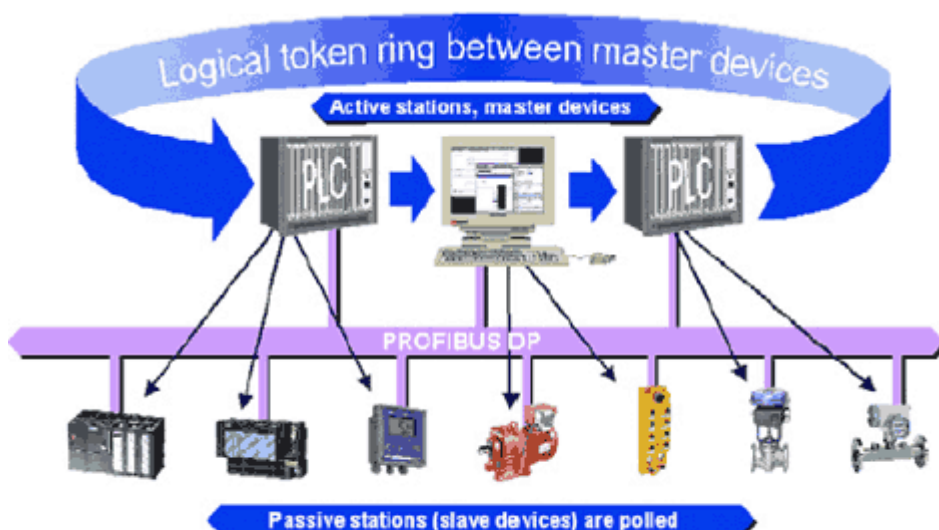
Рис. 5: Конфигурация PROFIBUS с активными ведущими и ведомыми устройствами.
