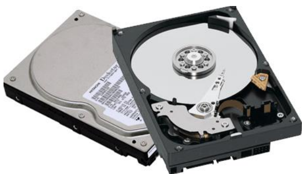
Рис. 9. HDD с интерфейсом SATA
