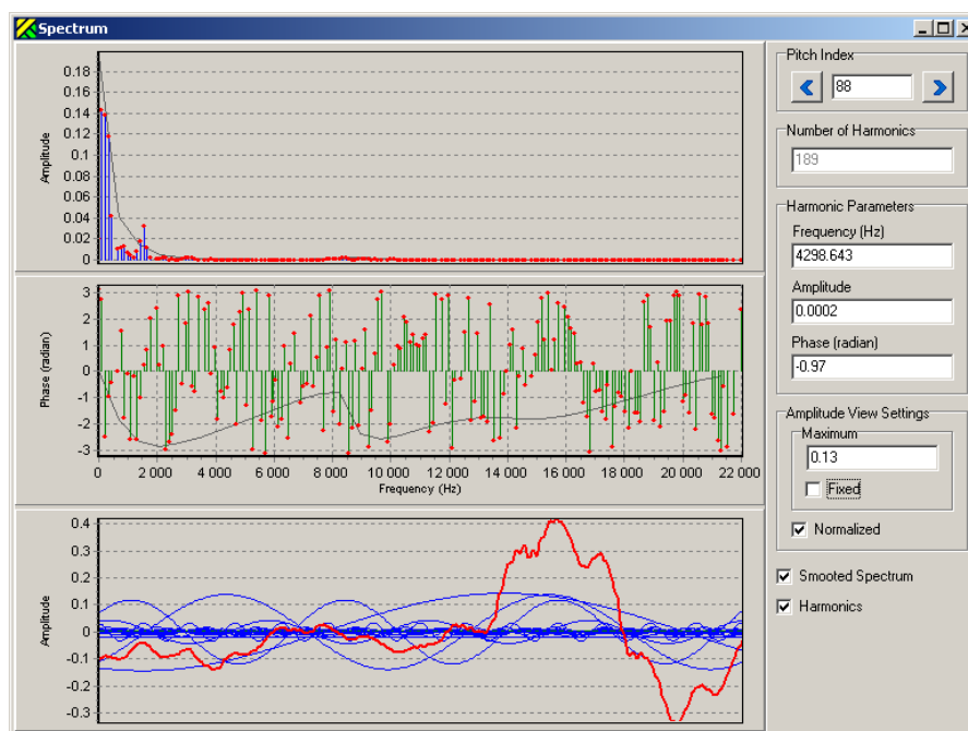
Рис. 7 Детальный гармонический спектр отдельного участка сигнала
