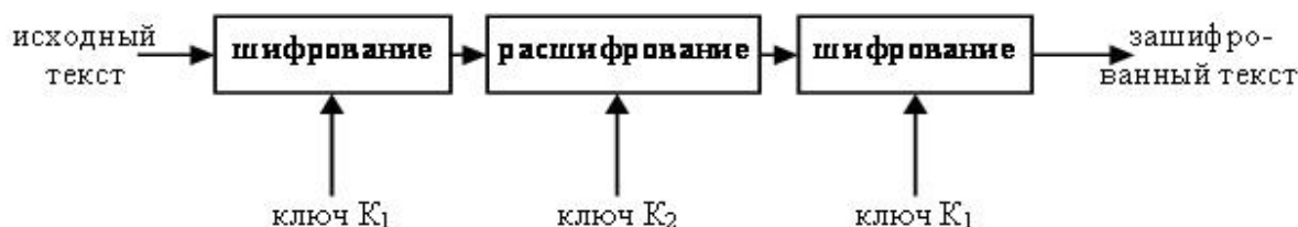
Рис. 4 Схема алгоритма 3DES
