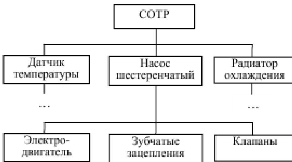
Сурет 2. Ғарыштық аппараттың жылу режимін қамтамасыз ету жүйесін декомпозициялау
