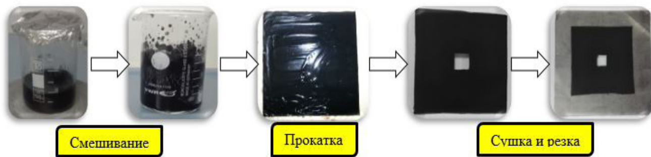
Рис. 1. Процедура изготовления электрода и заверенный электрод с размером 6 x 6 см 2
