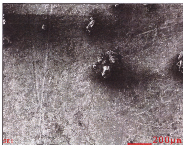
Рис. 3 – Поверхность электрода после электролиза при 1900 мВ
