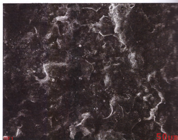
Рис. 4 – Поверхность электрода после электролиза при 2900 мВ
