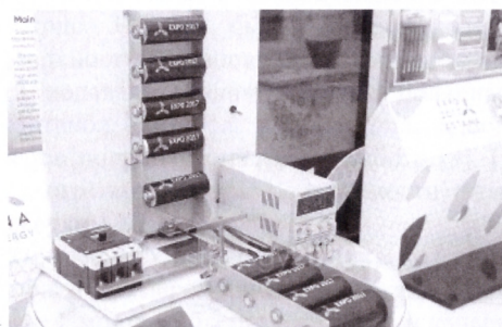
Рисунок 2. Фотография стенда, с визуализацией работы суперконденсаторного модуля
