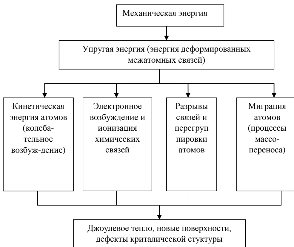
Рисунок 5 – Схема превращение энергии в твердых телах [51, с. 1032]
