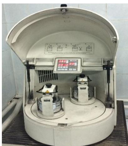
Рисунок 12 – Двухбарабанная центробежно-планетарная мельница “Пульверизетте 5” (FRITSCH, Германия)
