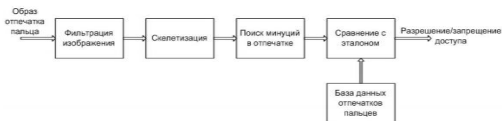
Рисунок 1. Схема алгоритма сравнения отпечатков пальцев с использованием особых точек
