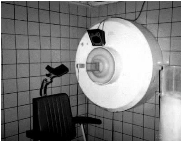
Рис. 2. Установка для терапии опухолей головы и шеи быстрыми нейтронами на циклотроне НИИЯФ ТПУ
