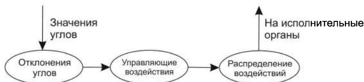
Рис. 6.10. Архитектура системы угловой стабилизации ЛА
