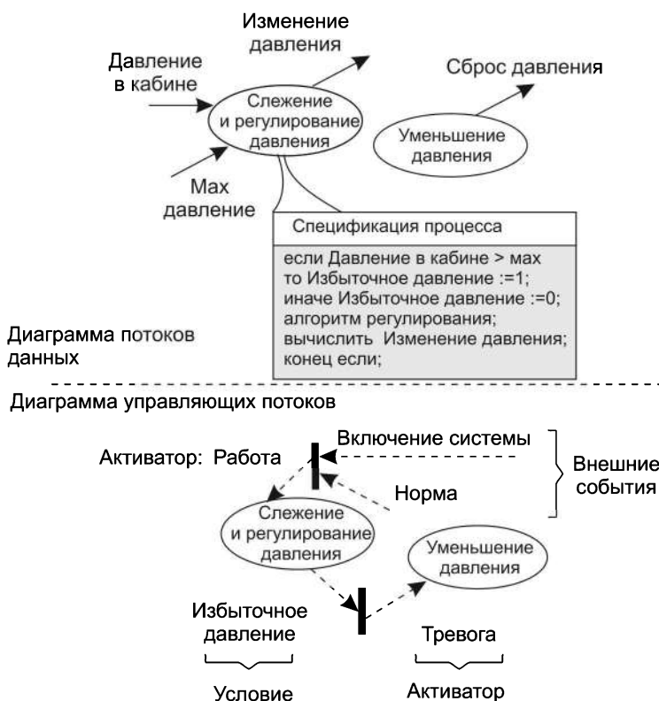
Рис. 5.9. Модель системы регулирования давления космического корабля
