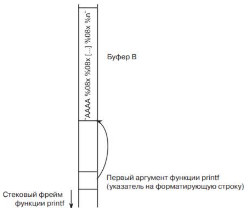
21-сурет. Пішімдеу жолын қолданатын шабуылдар. %08x таңбалардың нақты санын пайдалану арқылы кркер мүмкін пішімдеуші жолдың алғашқы төрт таңбасын мекен-жай ретінде пайдаланыңыз
