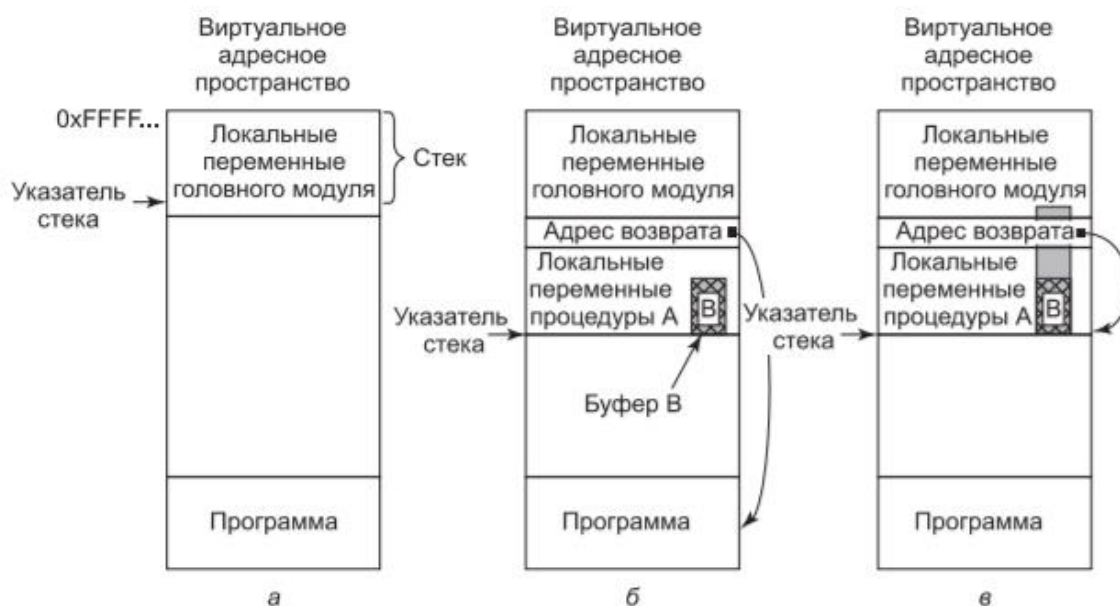
19-сурет. Қалыптасқан жағдайлар: а-негізгі программа жұмыс істеген кезде; б-а процедурасын шақырғаннан кейін; в-сұр түспен көрсетілген буфер толып кеткен кезде
