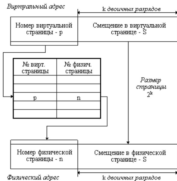
Рис. 2. Механизм преобразования виртуального адреса в физический при страничной организации памяти
