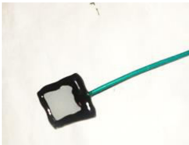
Рисунок 3.34 – Фотографическое изображение фотоанода ПЕС ячейки, выполненный на основе 2D массива ZnO декорированного наночастицами серебра
