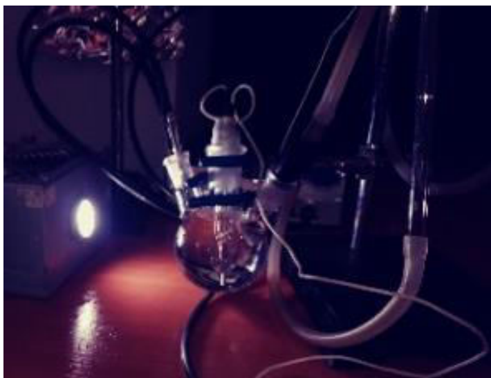
Рисунок 2.8 – а) Фото PEC ячейки для фотоиндуцированного разложения воды, б) схематическое изображение волюметрической установки
