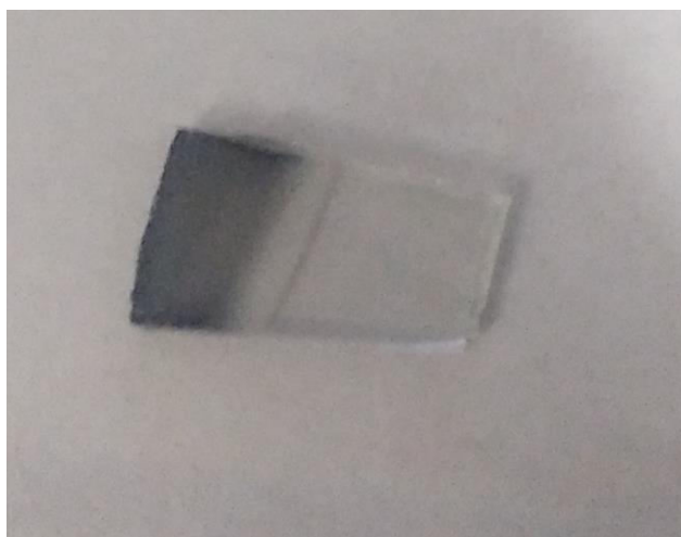
Рисунок 3.4 – Фотографическое изображение образца, синтезированного электрохимически в течении 5 минут при температуре 60°C
