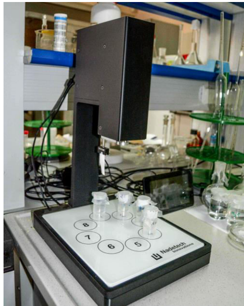
Рисунок 2.3 – Фотографическое изображение установки для LbL сборки
