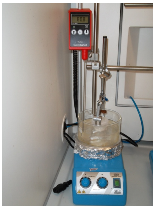
Рисунок 2.2 – Экспериментальная установка для получения вертикально ориентированных к поверхности подложки наностержней ZnO
