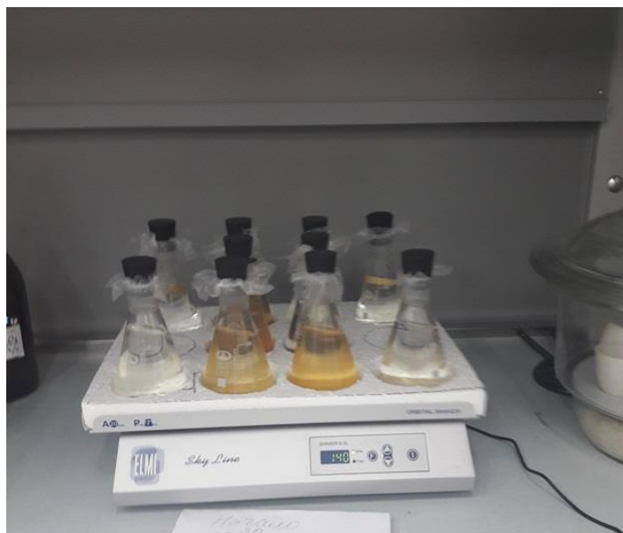
Рисунок 14 – Установка по десорбции скандия в статическом режиме
