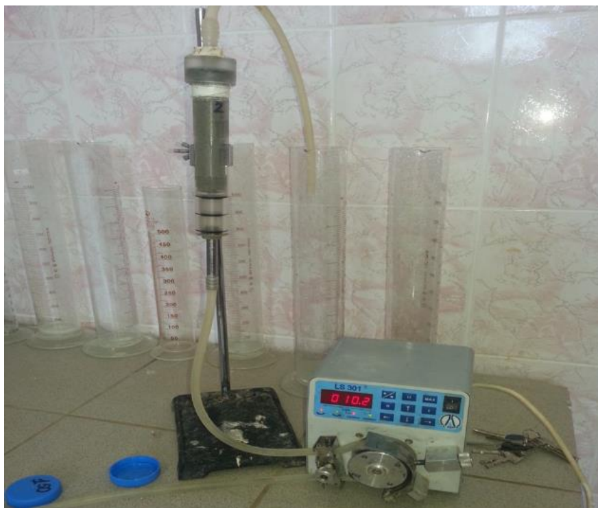
Рисунок 12 – Лабораторная установка для фильтрационного выщелачивания скандия из U – руды месторождения «б»
