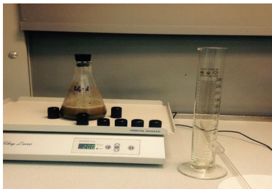
Рисунок 11 – Лабораторная установка для агитационного выщелачивания U – руды
